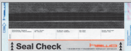
Siegelnaht optimal (Siegeltemperatur und Anpressdruck richtig eingestellt) Optimum seal seam (sealing temperature and pressure correctly set) Soudure idéale (température de scellage et compression sont correctement réglés)
